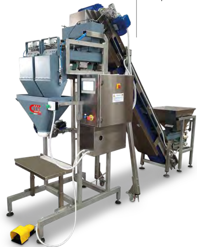
con doppia bilancia Versione speciale con parti lavabili e PLC Double weighers special version with washable parts and PLC Avec double balance version spéciale avec parties lavables et PLC
